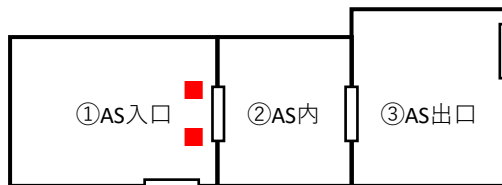
図1 除電装置設置図（■：除電装置） ①～③それぞれの箇所落下毛髪をカウント
