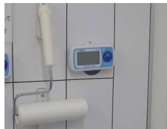
図2：非接触でカウントダウンが始まるタイマー。30-90秒でセットしている会社が多い。
